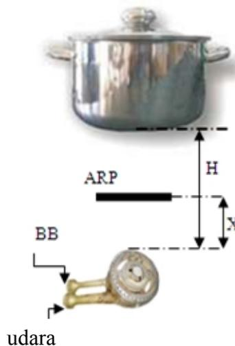
Gambar 2. ARP (alat radiator panas) diletakan di atas kepala kompor
